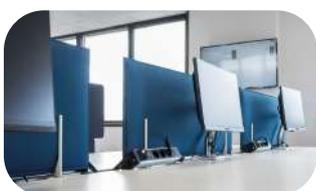
Il controllo dell'acustica non è solo una questione di comfort: è una condizione essenziale per la qualità didattica. I sistemi di fonoassorbimento attenuano riverberi e rumori di fondo, migliorando l'intelligibilità della voce, la resa delle apparecchiature audio e la gestione delle attività collaborative. Fondamentali in laboratori multimediali, linguistici o STEM, favoriscono attenzione, chiarezza e concentrazione.
